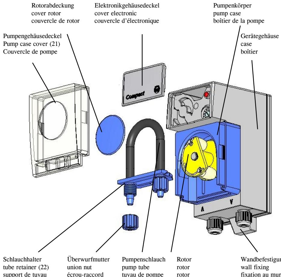
**Wichtig:** **Gerätegehäuse niemals öffnen!** Einzelteile können ohne Spezial-Werkzeug nicht mehr ordnungsgemäß zusammengesetzt werden
